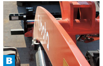
B Vue sur les point d'ancrage du lève palette
